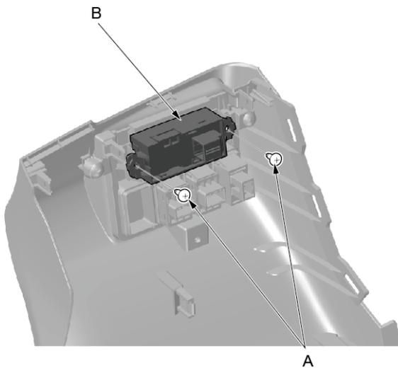
1. 使用十字起拆卸TRIP 和仪表亮度调节开关2个固定螺钉 (A) ， 取下TRIP 和仪表亮度调节开关 (B) 。
